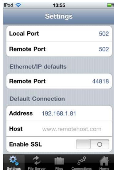
Abb. 6.3: Kommunikationseinstellungen in ScadaMobile
